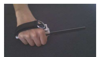
Mit einem Adapter kann das Messer auch in Schneidposition eingebaut werden !
