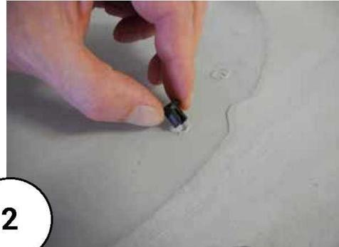
Zuerst muss der Clip mit der Nut in Längsrichtung ausgerichtet werden
