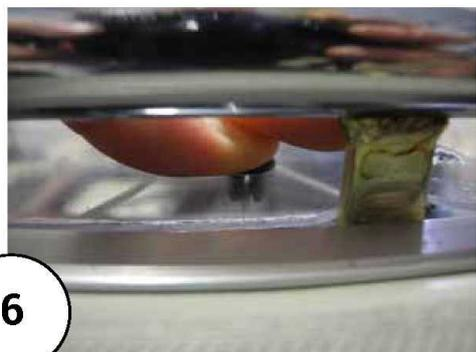
Wenn der Speichenschutz richtig ausgerichtet ist, wieder mit leichtem und gleichmäßigem Druck (wie bei Schritt 3) den Clip andrücken bis er einrastet
